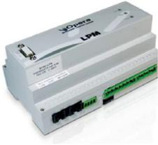
Le module LPM en armoire: Interface entre le courant porteur et les modules de LPL ou LPR . Il possède une mémoire de stockage de plusieurs jours. Génération d'alarme si une lampe ne communique plus. Autonomie sur batterie pour envoyer un signal d'alarme en cas de panne d'alimentation de l'armoire. 2 à 10 Scénarios indépendants possibles
