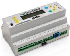
Le module DIMmy permet de télécommander d'autres appareils électriques comme des capteurs ou des contrôleurs de puissance. Il enregistre les paramètres électriques. il peut aussi contrôler les phases d'arrêt/démarrage via une horloge astronomique en option. Possibilité d'enregistrement des énergies électriques consommées en CPL ou de l'armoire de commande quand la passerelle est branchée en direct.
